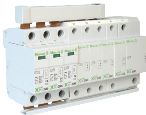
Rys. 1/5/15 Zestaw SP-B+C/3 zbudowany jest na iskiernikach SPI oraz warystorowych ogranicznikach przepięć klasy C. Oba typy są ze sobą zmostkowane tak, że w momencie uszkodzenia jednego z elementów układu można go wymienić.
