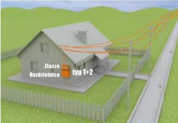
Budynek bez instalacji odgromowej zasilany linią napowietrzną. Zalecany montaż ogranicznika przepięć typu 1+2 (klasy B+C) SPB-12/280/.. w rozdzielni.
