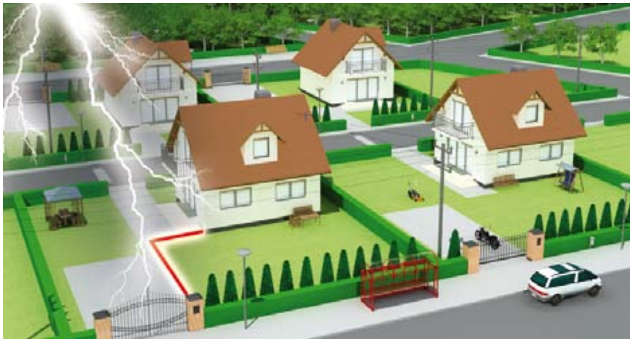
Rys.2 Bezpośrednie wyładowanie w bramę do której zamocowany jest domofon jako przykład przedostania się prądu piorunowego do instalacji elektrycznej budynku.
