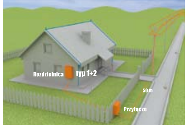
Budynek z instalacją odgromową zasilany linią kablową. Zalecany montaż ogranicznika przepięć klasy typu 1+2 (klasy B+C) SPB-12/280/.. w rozdzielni głównej.
