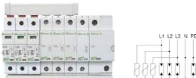
Rys.27 SP-B+C/3+1: widok aparatu oraz schemat jego połączenia. Jest to przykład ogranicznika typu 1+2 w połączeniu 3+1. Równolegle połączone warystory (typ 2) i iskierniki (typ 1) włączone są pomiędzy przewody fazowe i neutralny, iskiernik sumujący włączony jest pomiędzy przewód neutralny i ochronny, przepust łączeniowy ułatwia oprzewodowanie ogranicznika.
