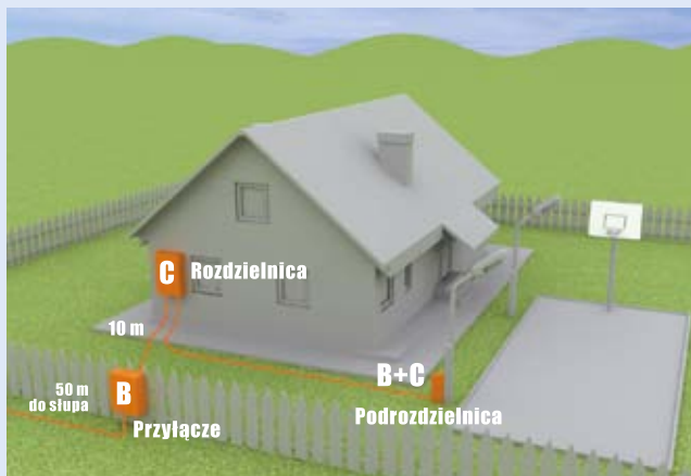
Budynek bez instalacji odgromowej zasilany linią kablową. Podrozdzielnica zasila oświetlenie obiektu rekreacyjnego. Montaż ogr.: przyłącze – typ 1 (klasa B), SPI-35/440 rozdzielnica główna – typ 2 (klasa C), SPCT2-280... podrozdzielnica – typ 1+2 (klasa B+C), SP-B+C/3...
